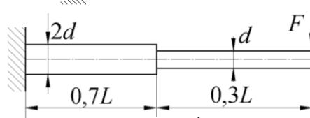
4. Za štap uklješten u točki C, oslonjen ležajima u B i opterećen vremenski promjenjivom silom  $F(t) = \hat{F} \sin(\omega t)$  prema slici, odredite promjer štap  $d$ . Materijal vratila je St 60 statičke čvrstoće  $\sigma_M = 600 \text{ N/mm}^2$ . Skicirajte i kotirajte ciklus naprezanja za kritični presjek.
