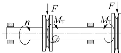
2. Za prostorni nosač prema slici opterećen silama, provjerite uvjet čvrstoće, prema teoriji najvećeg posmičnog naprezanja. Cijev je okruglog šupljeg presjeka. Skicirajte i kotirajte dijagrame momenata uvijanja i savijanja. Zadano:
